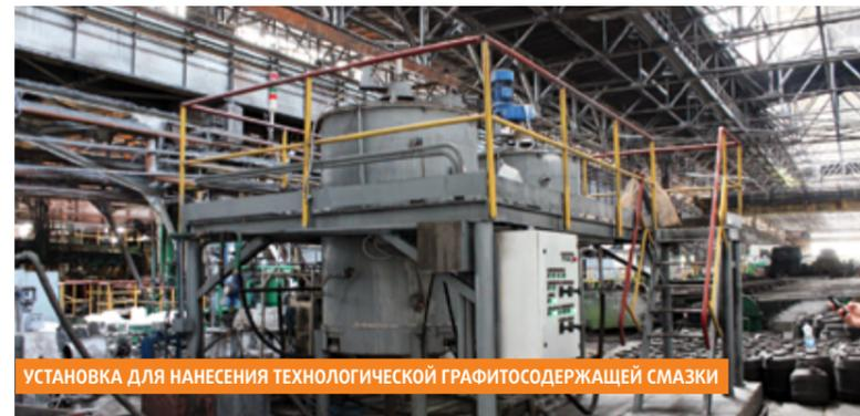
УСТАНОВКА ДЛЯ НАНЕСЕНИЯ ТЕХНОЛОГИЧЕСКОЙ ГРАФИТОСОДЕРЖАЩЕЙ СМАЗКИ
