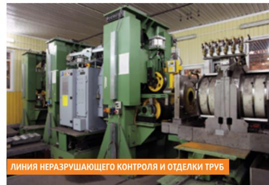
ЛИНИЯ НЕРАЗРУШАЮЩЕГО КОНТРОЛЯ И ОТДЕЛКИ ТРУБ
