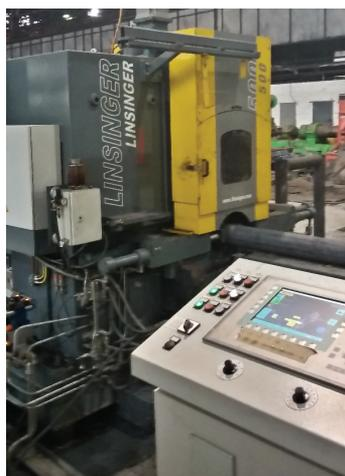
Ранее раскрой заготовки для обеспечения производства всех заказов выполняли пресс-ножницы и установленная в 2008 г. пила порезки Linsinger KSA-500. Теперь порезка осуществляется на двух идентичных пилах, исключив из производственной цепочки пресс-ножницы. Это позволило повысить точность раскроя заготовки и обеспечить ее стабильное качество. Высокое качество заготовки позволяет избежать образования дефектов геометрии и наружной поверхности труб.
