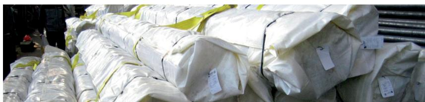
Также используется уникальный вариант двухслойной упаковки, которая защищает поверхность металла от коррозии. Она состоит из специального слоя полиэтиленовой пленки, пропитанной антикоррозийным ингибитором «ZIRAST», который защищает от воды.
